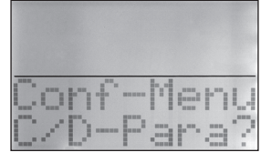
Fig. 28: Configuring charge / discharge parameters
