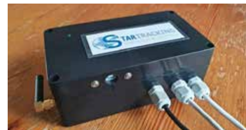
De 'Roosmux' is het hart van het systeem, die alle apparatuur met elkaar verbindt.
