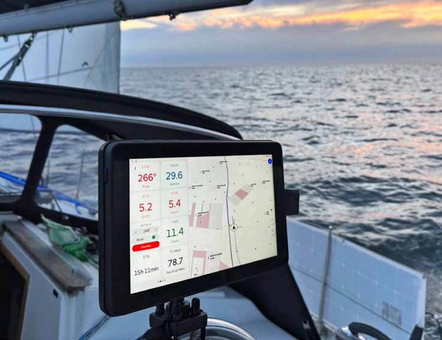
Het nieuwe Orca-systeem kan op alle schermen dezelfde informatie tonen. Hier is het scherm als plotter ingesteld.
